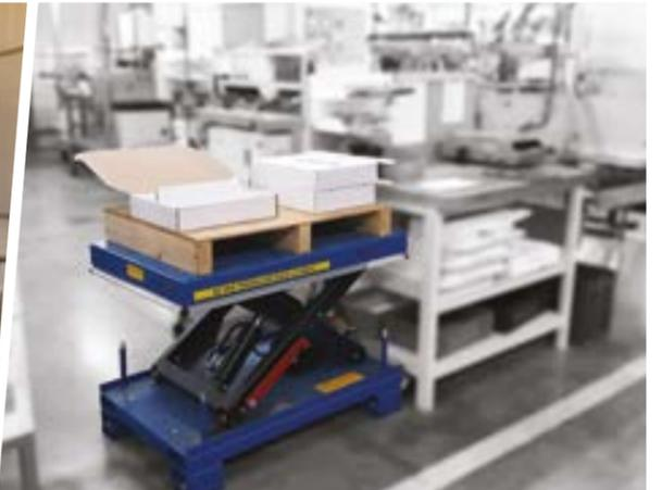
Table élévatrice sur embase palette pour la mise à hauteur au poste de conditionnement
