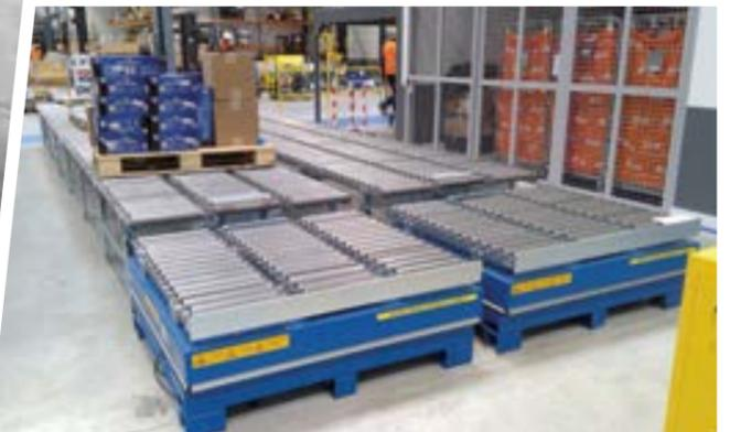
Table élévatrice sur embase palette avec convoyeur à rouleaux, pour accumulation de palettes en bout de ligne
