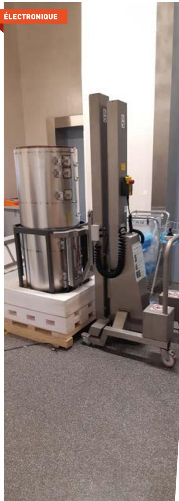
Mini gerbeur inox avec mât télescopique, contre poids et support fût
