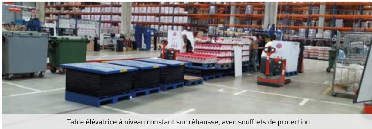
Table élévatrice à niveau constant sur réhausse, avec soufflets de protection
