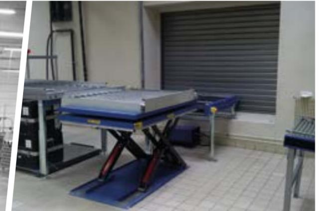
Table élévatrice avec plateau tournant et convoyeur à rouleaux
