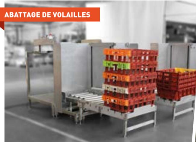
Empileur avec convoyeur intégré, ligne de conditionnement
