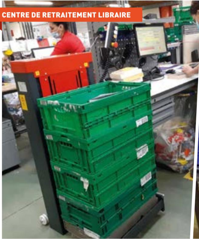
Mise à hauteur de bacs sur un poste de tri
