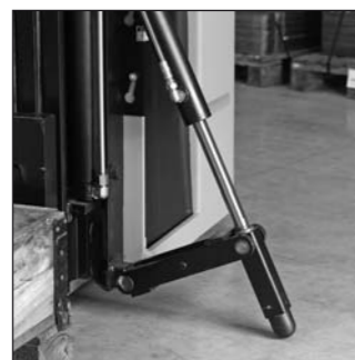
La capacité résiduelle à des hauteurs plus élevées peut être augmentée à l'aide de stabilisateurs latéraux (de série sur mât triplex).
