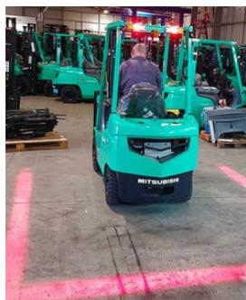
Des capteurs de présence, des gyrophares, des sièges pivotants pour la marche arrière, système d'avertissement sonore pour les surcharges.
